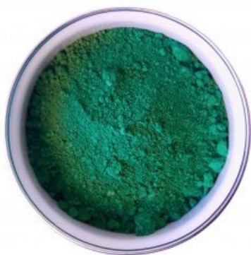
Fig. 18. På samme vis peger analysen på, at de yngre grønne malingslag indeholder det syntetisk organiske pigment phtalocyaningrøn. Fotografiet viser rent phtalocyaningrøn pigment.
